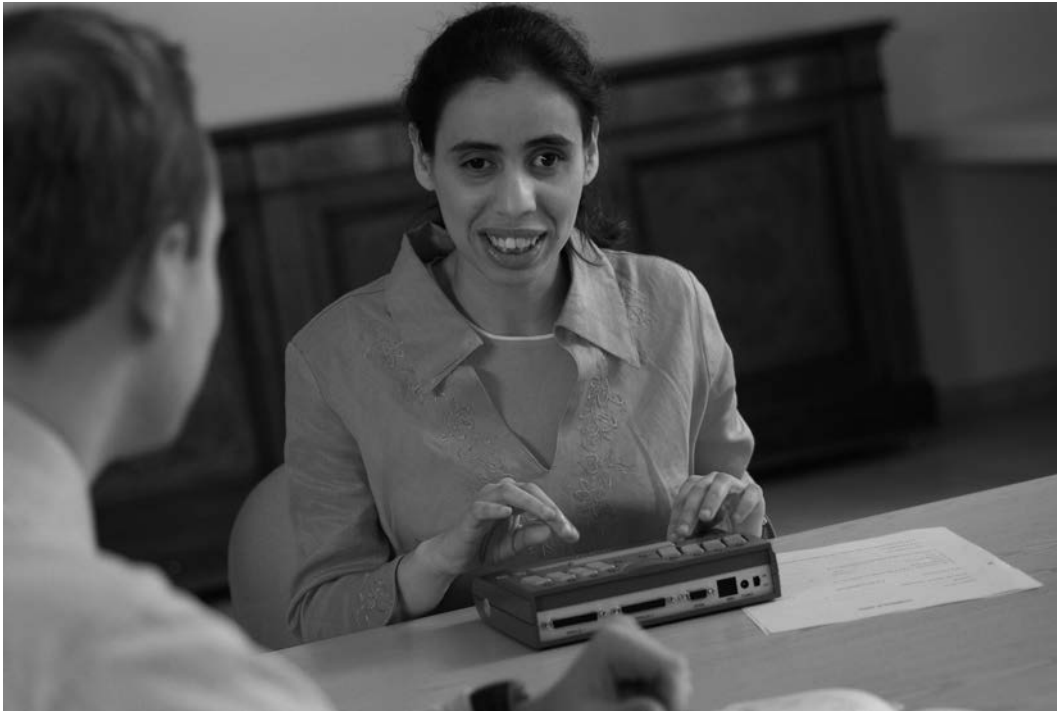
Een brailnotenotietoestel om een vergadering bij te wonen.
